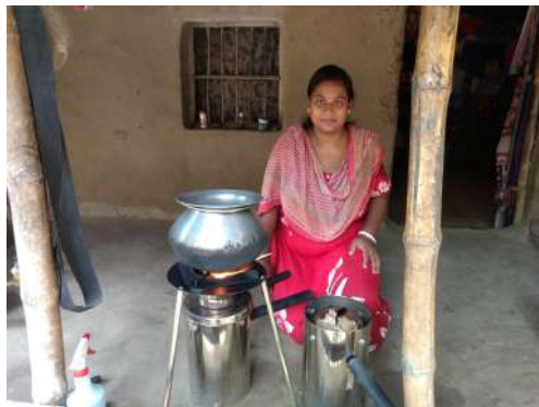
Effizienter Holzvergaserofen ermöglicht ein rauchfreies Kochen und produziert Holzkohle für eine Familie in Indien.
